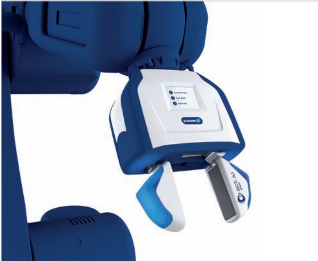
Dotykový displej v kryte uchopovača a LED panely v prstoch umožňujú priamu komunikáciu s operátorom.
