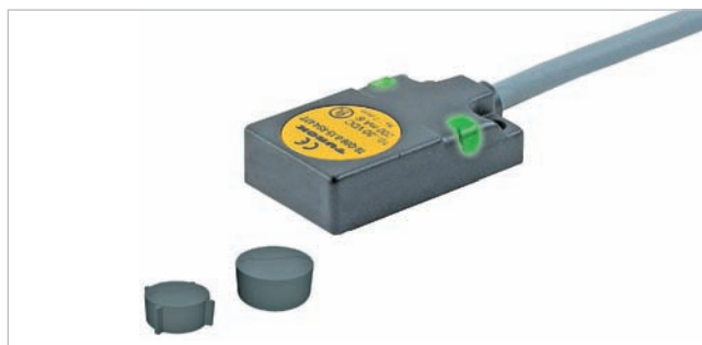
Obr. 3 Kompaktná ochrana značky s funkciou hesla: dátové nosiče R10 a R12 na umiestnenie na kovové objekty a kompaktná zapisovacia/čítacia hlava TB-Q08 od spoločnosti Turck
