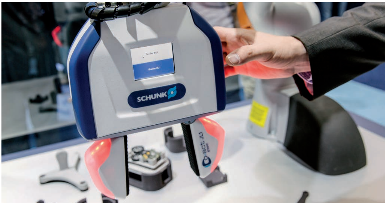
Prostredníctvom kapacitného senzorového systému deteguje Co-act JL1 ľudský kontakt a automaticky prechádza do bezpečného prevádzkového zastavenia.
