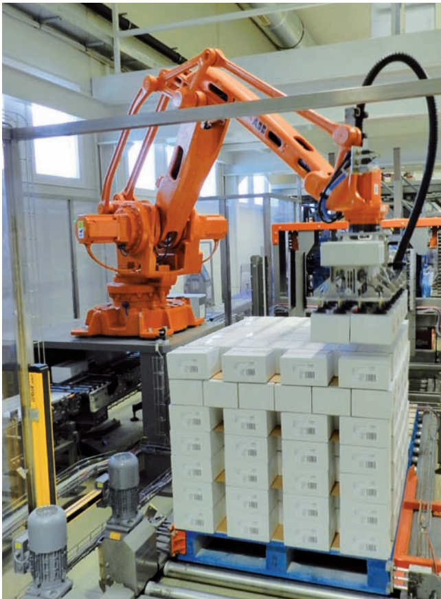
Štvorosový robot IRB 460 od spoločnosti ABB zoberie pomocou uchopovacieho zariadenia vybaveného prísavkami škatule s čokoládovými tyčinkami a podľa tzv. paletovej schémy ich natočí a uloží na paletu.
