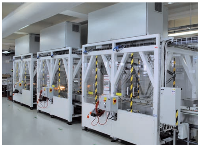
Tri bunky, v ktorých pralinky ukladá šesť delta robotov ABB FlexPicker 360.
