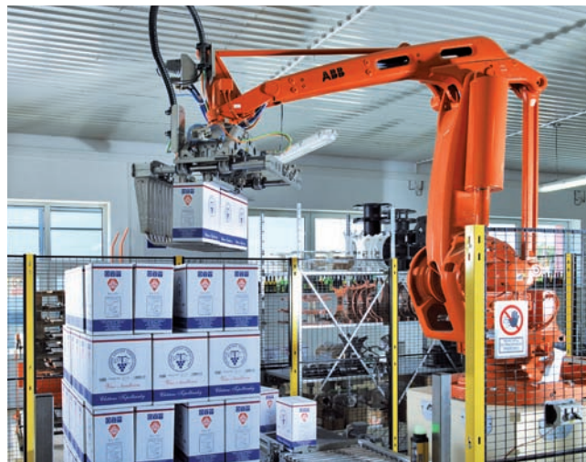
Robot IRB 660 od spoločnosti ABB dokáže na paletu ukladať niekoľko rôznych druhov kartónov s fľašami vína.
